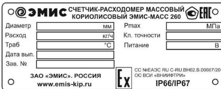
Рисунок 7.1. Шильда электронного блока.
