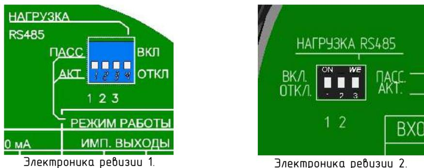
**Рисунок 4.1 Переключатель активного/пассивного частотно-импульсных и дискретного выходов.**
